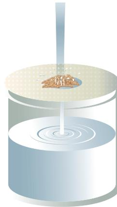
**Filtración.** Se basa en que alguno de los componentes de la mezcla no sea soluble en el otro, de modo que uno permanezca sólido y el otro líquido. La mezcla se deposita en una coladera o un papel filtro; el componente sólido se quedará en el filtro y el otro pasará. Se pueden separar sólidos de partículas sumamente pequeñas utilizando filtros con poros del tamaño adecuado.
