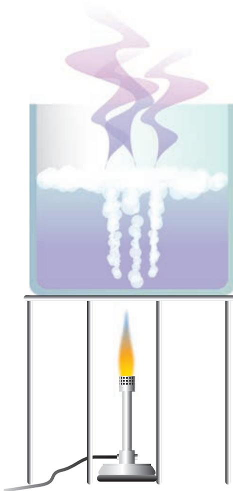
**Evaporación.** Consiste en calentar la mezcla hasta el punto de ebullición de uno de los componentes, pues se evapora primero el que tenga el punto de ebullición de menor temperatura. Los otros componentes quedarán en el recipiente cuando aquél se haya evaporado.
