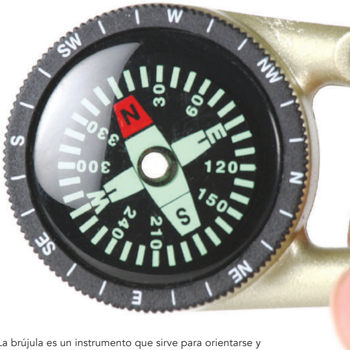
La brújula es un instrumento que sirve para orientarse y utiliza el magnetismo para su funcionamiento. La aguja siempre señala el norte magnético de la Tierra.
