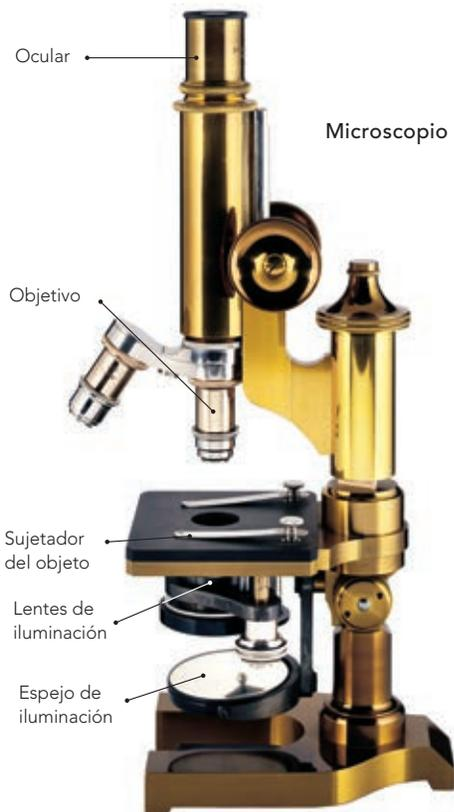
El microscopio óptico funciona con varias lentes que sirven para amplificar objetos muy pequeños o que no se pueden observar a simple vista (objetos microscópicos).
